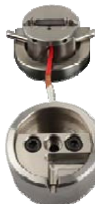
Rollenspannzeug 1kN, Exzenter 0\ldots 7\text{mm} zur Zugfestigkeitsprüfung an geschweißten Draht- und Kabelverbindungen Art.Nr.: FMT-932WT
